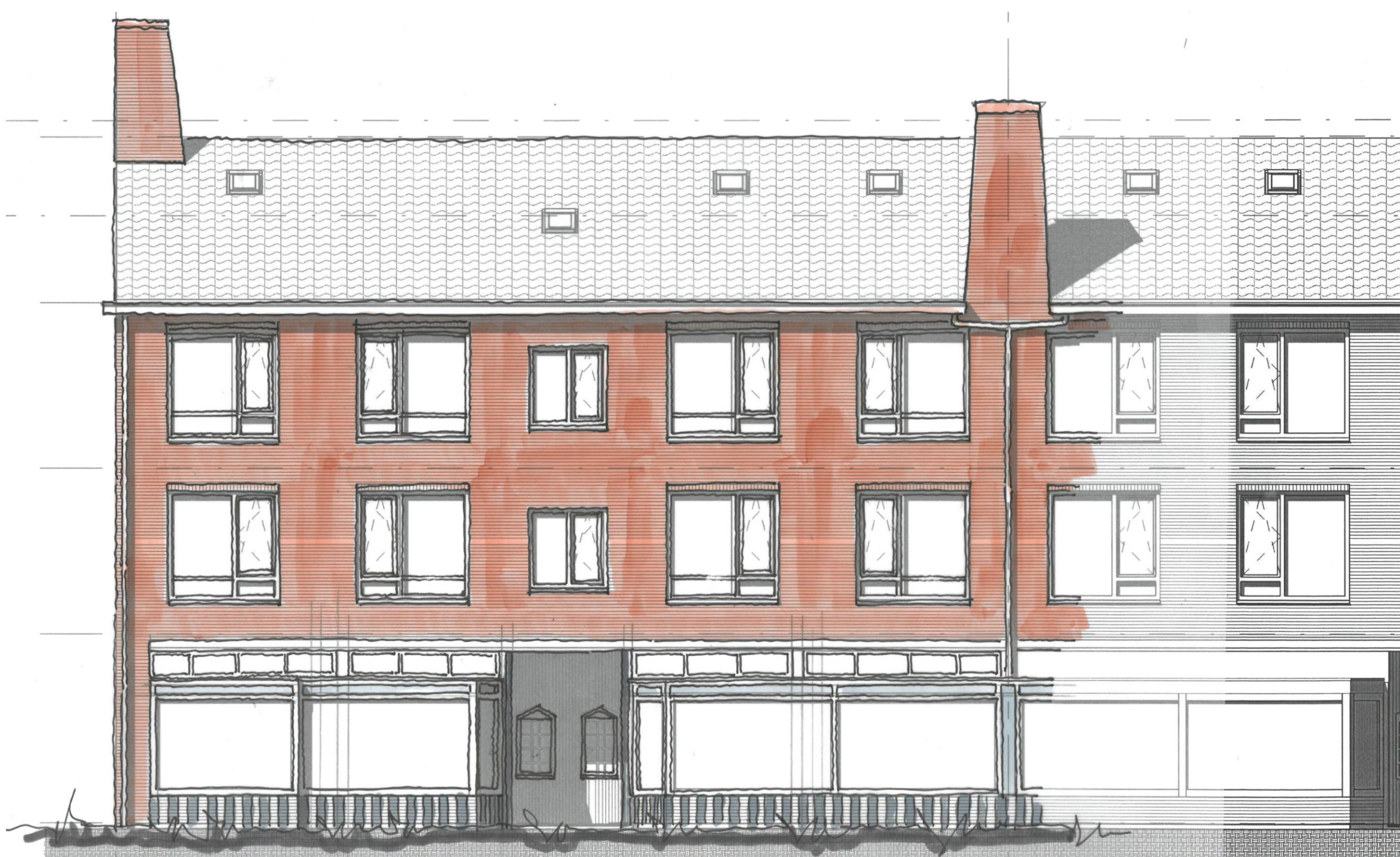
Voorgevel Blok 2 oorspronkelijke toestand glasstrook boven de vitrines en een betegelde plint
